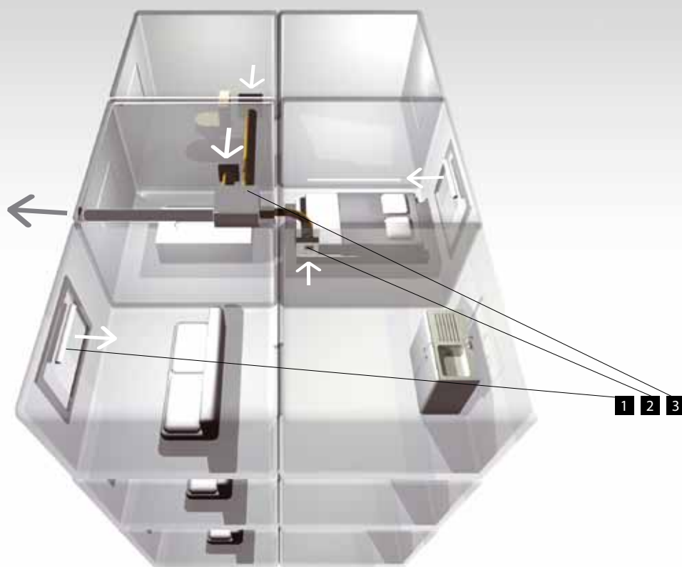
1. Приточные устройства. 2. Вытяжные устройства. 3. Вентилятор
